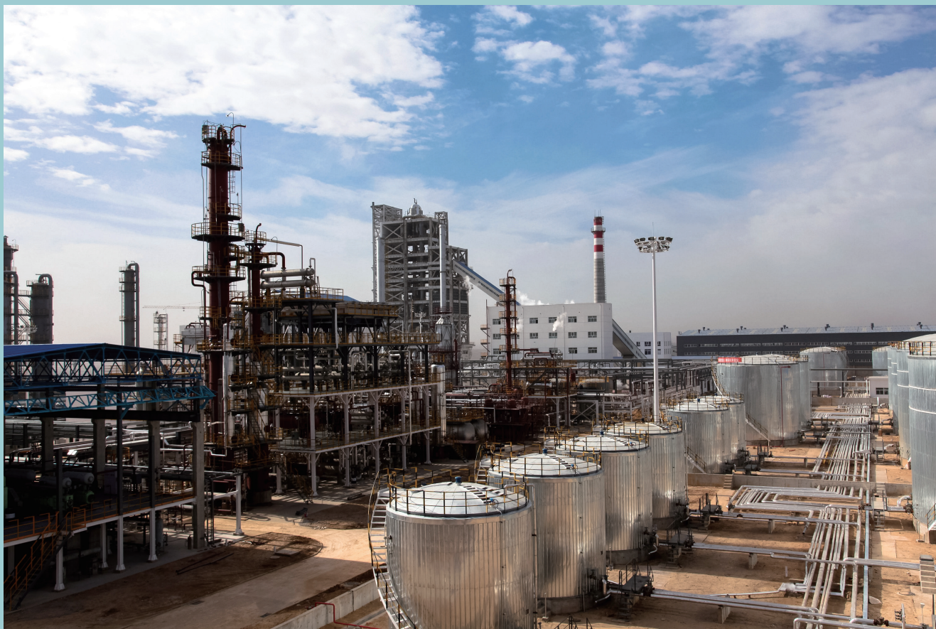
陕煤化集团所属的神木富油能源科技公司中低温煤焦油轻质化技术装置
