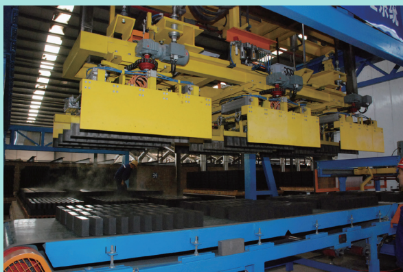
中煤金海洋能源有限公司年产2亿块煤矸石烧结砖生产车间
